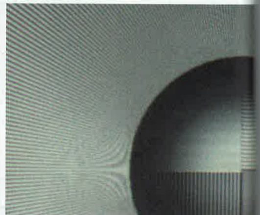
Der diagonale Pixelshift von XPR erzeugt mess- und sichtbar einen Auflösungsbonus horizontal im Vergleich zu vertikal.
