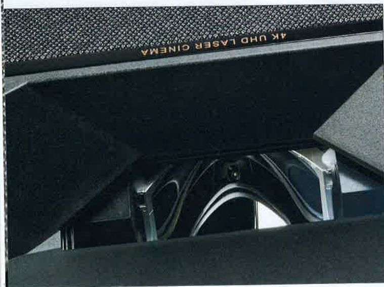
Trotz aufwendiger Optik mit Umlenkung über einen Spiegel hat der Optoma eine enorme Lichtausbeute
