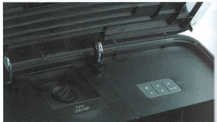
Die Tasten zur Bedienung des Menüs sowie die manuellen Regler für Zoom und Lens Shift befinden sich beim Optoma hinter einer Klappe im Deckel und sind aus manchen Positionen ungünstig zu erreichen.
